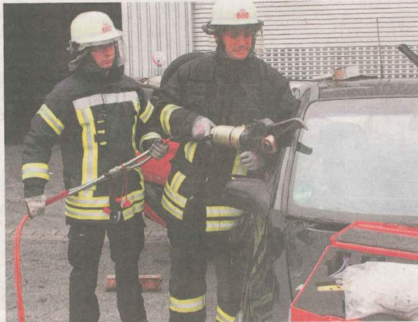
Mit der Sicherheitsschere wird die A-Säule des Kleinwagens durchtrennt. So können im Auto eingeklemmte Personen leichter befreit und schneller gerettet werden. —FOTOS: KOHRING
